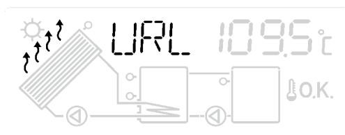
Ilustracja 8: Migający symbol strzałki i napis URL zamiast napisu KOL sygnalizuje tryb urlopowy.
